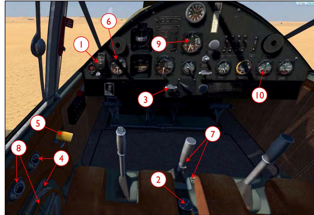
**Fahrwerk:** Das Fahrwerk durch auf- und abpumpen des Hebels (7) bedienen (nur unter 180 km/h!); Zum Einfahren den Hebel (7a) im Uhrzeigersinn drehen, zum Ausfahren im Gegenuhrzeigersinn. Die mechanische Anzeige (7b) gibt die Stellung des Fahrwerks wieder. Zum vollständigen Ein- oder Ausfahren muss der Hebel 40 bis 45 Mal betätigt werden (ca. 20 Sekunden). Wenn sie den Schub ganz herausnehmen, ertönt ein Alarm, falls das Fahrwerk nicht ganz ausgefahren ist.
