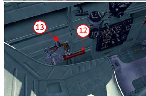
Fahrwerk- und Landeklappenkontrollen (links)
